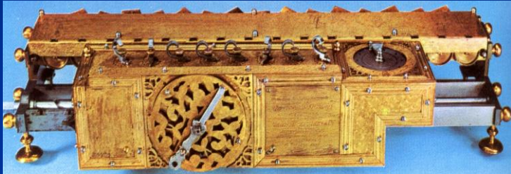
Multiplikationsmaschine Leibniz, 1693 (Schaltklinke)
