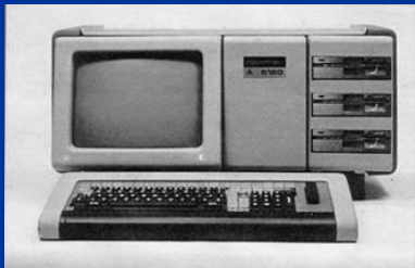
1985: A 5120 Robotron, 5,25"- Disketten, Betriebs- System: MS-DOS var.
