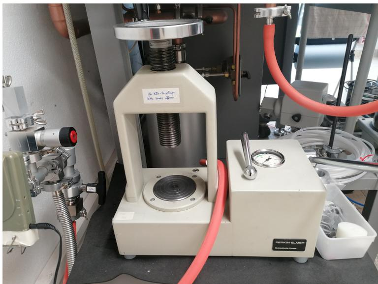
**Abbildung 3.2:** Die Abbildung zeigt die Presse für die Presslingsherstellung.
